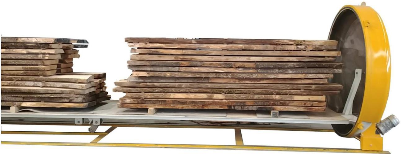
Les séchoirs EMV peuvent être dotés de pompes à vide à eau ou à huile, le système de chauffage peut fonctionner à l'eau chaude grâce à des radiateurs spéciaux ou à l'électricité grâce à des résistances chauffantes. En combinant une ou plusieurs pompes à vide à huile et un système de chauffage électrique, vous pouvez obtenir une machine vraiment polyvalente qui ne nécessite qu'un laçage à force EM et une décharge d'eau de bois et qui peut être déplacée facilement en cas de nécessité.
