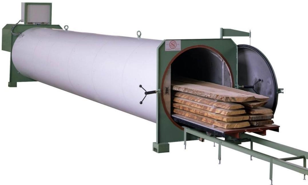
Le gradient d'humidité nécessaire entre ambiance et matériel, est constamment maintenu au moyen d'un condensateur qui fait précipiter la vapeur en suspension.
