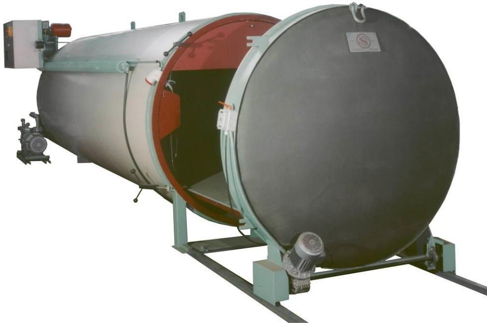
La machine EMV, fonctionnant à basse température, permet l'évaporation de l'eau dans le bois de traitement sans le soumettre à des démarrages thermiques qui peuvent provoquer des déformations et des fissures.
