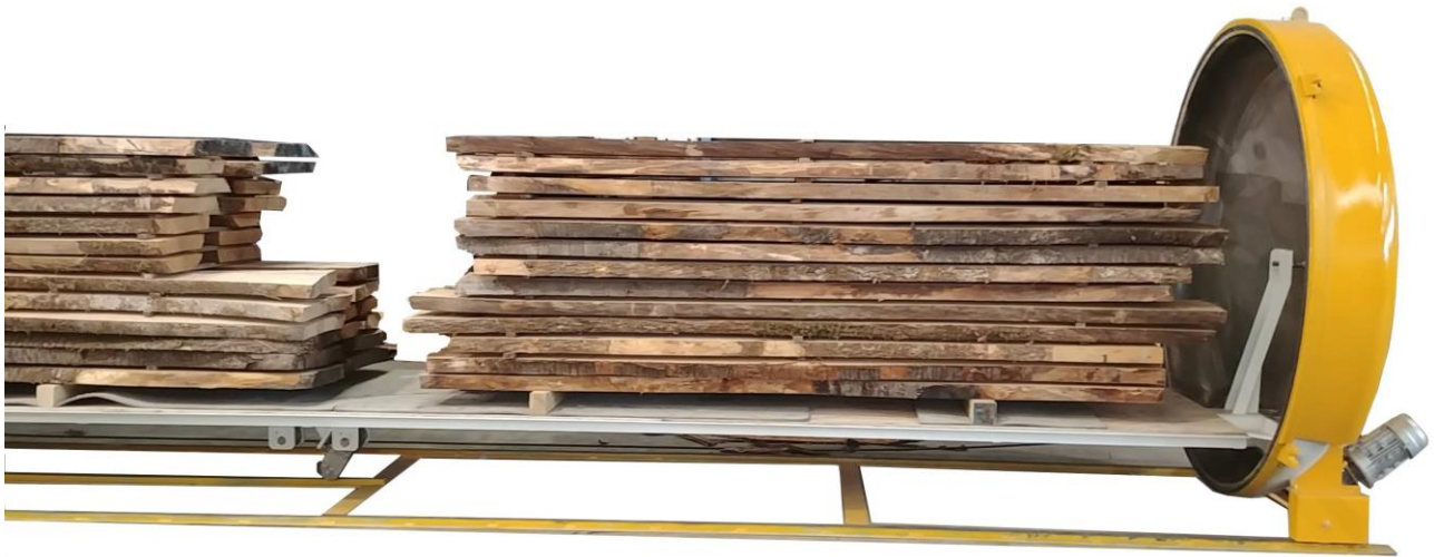
Figura 5.2: carrello di carico con catasta di tavole listellate pronte per il carico in autoclave
