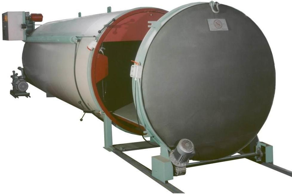
La máquina EMV, trabajando a baja temperatura, permite la evaporación del agua en la madera tratada sin someterla a arranques térmicos que pueden causar deformaciones y grietas.
