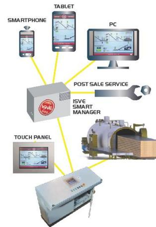
**SOFTWARE AVANZADO:** un innovador software de control que permite almacenar hasta 8 ciclos de secado diferentes. De esta manera el operador podrá seleccionar el programa de trabajo más adecuado según la esencia de la madera.
