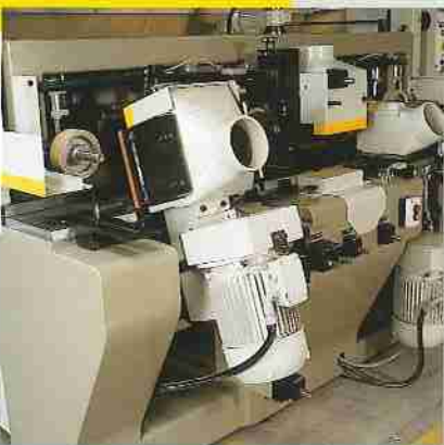
5) ACCESSORI - Lubrificazione automatica del piano - Piani scanalati per pezzi corti - Gruppi avanzamento supplementari - Piano di lavoro mobile dopo albero universale - Rullo di traino inferiore motorizzato - Pressoi per pezzi corti davanti toupie dx - Motori con potenze fino a 15 HP - Ricerca automatica della larghezza pezzo per toupie sx. - Visualizzatore elettronico avanzamento, contatore, luci cabine.
